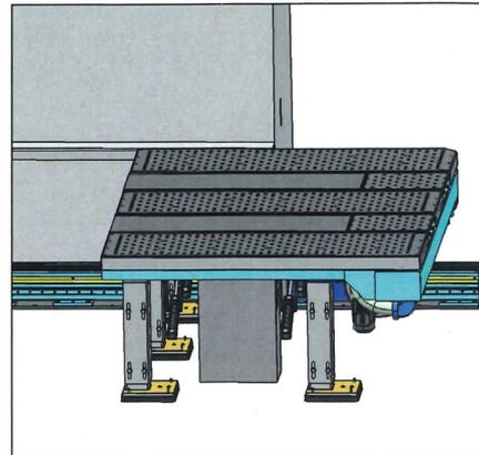
Der HOLZMA Luftkissen-Drehtisch ist erste Wahl für alle, die mit großen Paketen arbeiten: Statt die Streifen oder Platten nach dem Längsschnitt mühsam von Hand neu auszurichten, drehen Sie jetzt einfach den Tisch – über die vollautomatische Drehvorrichtung.
